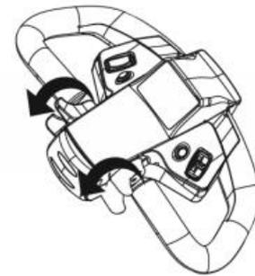
**!** Кнопка управления направлением и скоростью автоматически вернется в исходное положение, когда палец будет отпущен, и штабелер затормозит. Поэтому штабелер должен продолжать работать, пока палец не отпущен.
