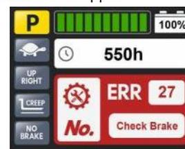
При возникновении неисправности, если подтверждено, что это не ошибка в проводке или механическая неисправность автомобиля, можно попытаться перезапустить его с помощью ключа-выключателя автомобиля. Если неисправность сохраняется, выключите ключ, проверьте, правильно ли подключен или загрязнен разъем, отремонтируйте и очистите его, снова подключите, а затем повторите попытку.
