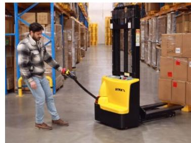
Когда грузовик опущен, отпустите тормоз, чтобы переместить агрегат вручную.
