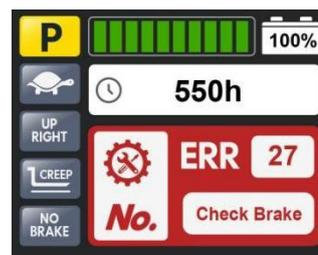
Quando si verifica un malfunzionamento, se viene confermato che non si tratta di un errore di cablaggio o di un guasto meccanico del veicolo, è possibile tentare di riavviarlo tramite l'interruttore a chiave del veicolo. Se il guasto persiste, spegnere l'interruttore a chiave, controllare se il connettore è correttamente collegato o sporco, ripararlo e pulirlo, ricollegarlo e quindi riprovare.
