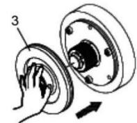
– Instale el conjunto del estator (2) en el disco de fricción (5) utilizando tres tornillos de montaje del freno (1).
