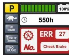
Quando ocorre uma avaria, se se confirmar que não se trata de um erro de cablagem ou de uma avaria mecânica no veículo, pode tentar-se reiniciá-lo através do interruptor da chave do veículo. Se a avaria persistir, desligar o interruptor de chave, verificar se o conector está corretamente ligado ou sujo, repará-lo e limpá-lo, voltar a ligá-lo e tentar novamente.
