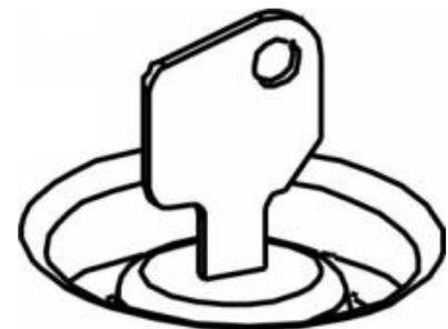
Quando o condutor abandona o empilhador, a remoção da chave de bloqueio do interruptor garante que o empilhador não arranca inesperadamente.
