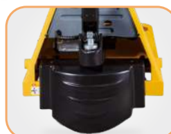
Copertura di protezione Proteggi il motore di azionamento, Anti-calpestio
